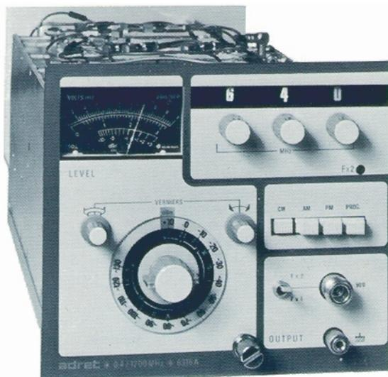
Le tiroir 6316A est la version du 6315A muni d'un doubleur de fréquence, ce qui permet d'atteindre 1,2 GHz en deux gammes.
