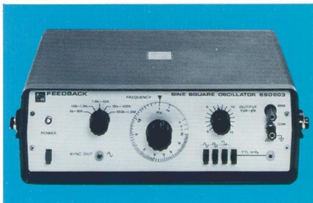
D'un prix extrêmement compétitif, le générateur SSO 603 délivre des signaux sinusoïdaux et carrés dans la bande 10 Hz à 1 MHz avec un niveau maximum de 15 Vcc.
