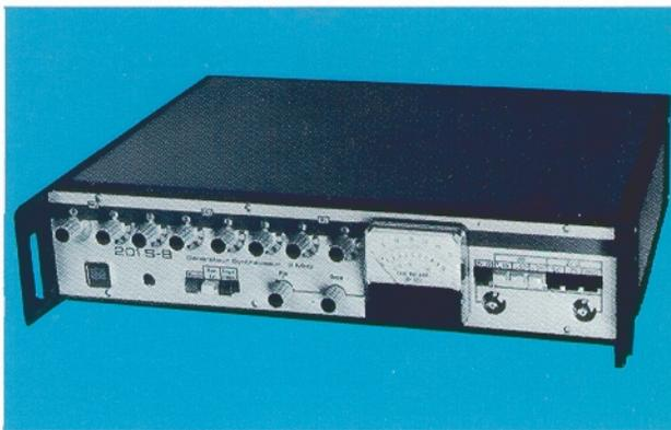
Le générateur synthétiseur type 201 SB couvre la bande de 0,1 Hz à 2 MHz en une seule gamme ; sur option cet instrument peut être équipé d'une sortie décalée de 2 MHz par rapport à la sortie principale qui permet le pilotage de la voie oscillateur local d'un voltmètre sélectif; l'ensemble synthétiseur voltmètre sélectif offre ainsi la possibilité d'effectuer des mesures sélectives jusqu'à 1,3 MHz.
