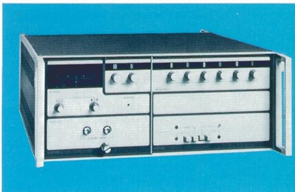
Le tiroir 6301 E, incorporé dans le bâti 6101 B de la série 6000\*, constitue une référence de fréquence et de niveau dans la gamme de 100 Hz à 100 MHz. L'affichage de la fréquence s'effectue soit en mode Local par l'intermédiaire de 8 commutateurs décimaux, soit en mode Distance à partir de signaux BCD de programmation avec un temps d'acquisition de l'ordre de 1 ms.
