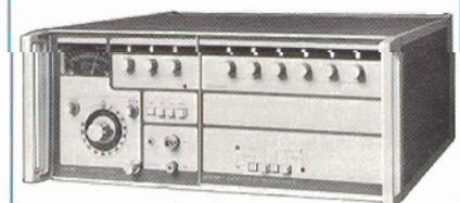
Le niveau de sortie nominal est de + 3 dBm (316 mVeff/50  $\Omega$ ) et il s'ajuste toujours à l'aide de l'atténuateur, des verniers et du galvanomètre; la dynamique est la même qu'en gamme « directe », 153 dB, mais l'atténuateur n'est spécifié que jusqu'à - 100 dBm.
