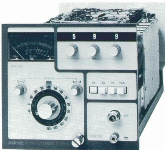
Avec le tiroir de sortie 6315 A, la gamme couverte va de 400 kHz à 600 MHz et le signal de sortie peut être modulé en phase, en amplitude et en fréquence.
