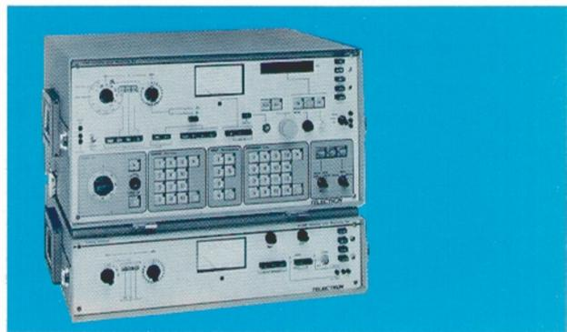
Le banc de test semi-automatique référence SLM 960/4 est destiné à la mesure sélective de niveau sur les systèmes de transmission à courants porteurs.
