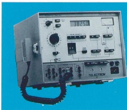
Le banc de test universel STS 7/30 est principalement destiné à la maintenance et au test des circuits de signalisation TRON et RON (transmission et réception) sur les lignes téléphoniques. Ce test s'effectue par l'envoi d'impulsions référencées à un oscillateur à quartz; la distorsion de l'impulsion de retour est mesurée sur le galvanomètre incorporé. Cette nouvelle méthode permet une grande précision dans les mesures ainsi qu'un gain de temps appréciable.
