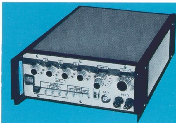
Le générateur synthétiseur type 301 couvre la bande de fréquence de 0,1 Hz à 100 kHz en trois gammes.
